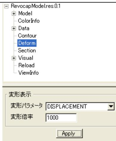
このとき、Apply ボタンを押すと、変形倍率の分、変位が強調されたモデルの表示がされます。また Apply ボタンは Cancel ボタンに変化します。
