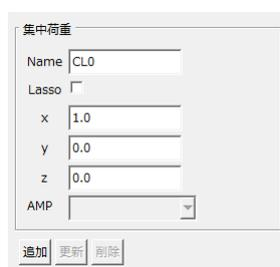
正しく設定されると、3DView の中で集中荷重が与えられた節点にマーカーが表示され、TreeView では CLOAD の下に 1 つの荷重条件を表す項目が追加されます。
