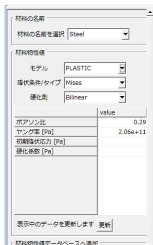
TreeView の計算格子で bodycs\_0 の領域の材料の名前を Steel で与えて、材料モデルを PLASTIC(Mises-Bilinear)とします。
