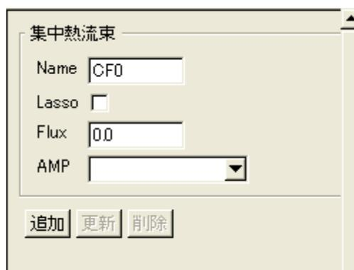
図 9-23 集中熱流束(CFLUX)
